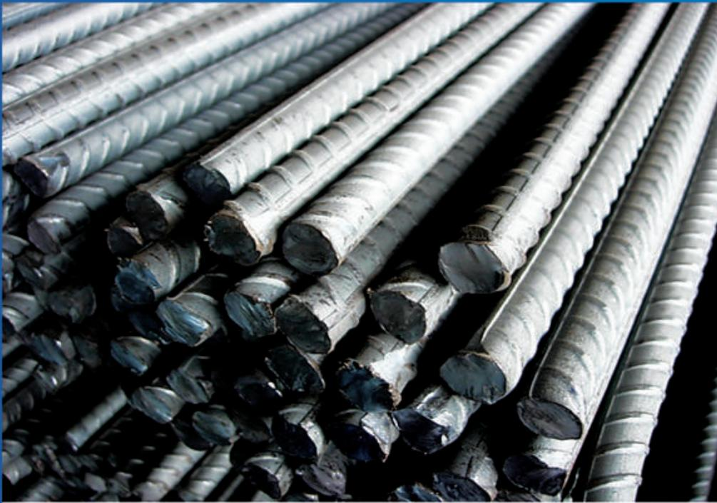
Las barras corrugadas son utilizadas para construcciones sismoresistentes como edificios, puentes. Los resaltos o corrugas que mejoran la adherencia con el cemento.
